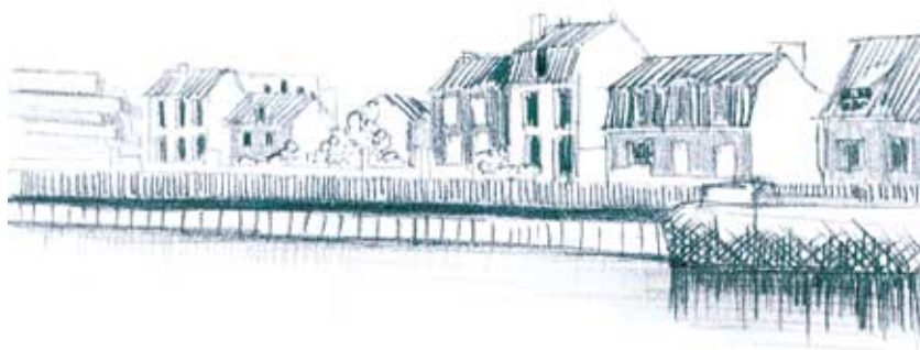
Les berges verticales du centre ville permettent aux péniches d'accoster pour une manipulation aisée du chargement.
