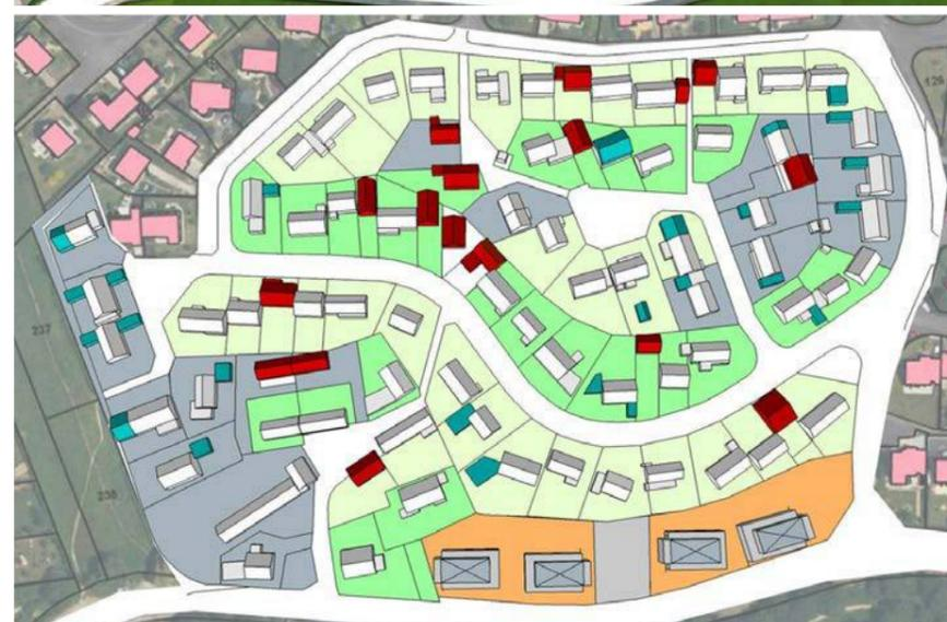
Lotissement existant et le projet après mise en œuvre de différentes procédures d'urbanisme : densification arrière, densification en front de rue, extension, rehaussement, acquisition/démolition/reconstruction
