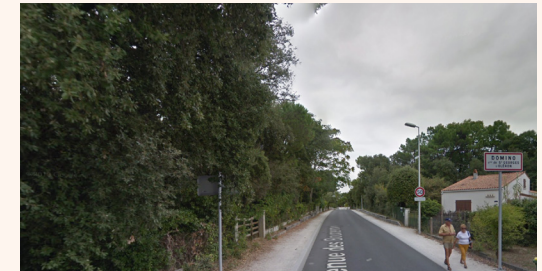
Exemple négatif / Entrée de ville à la campagne / Mauvais positionnement du panneau d'entrée à Domino : l'urbain n'est pas encore perceptible, à reculer vers le centre bourg
