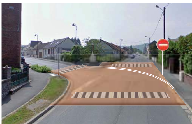
Carrefour rue Saint-Louis / rue du calvaire Marquage du seuil de la rue résidentielle
